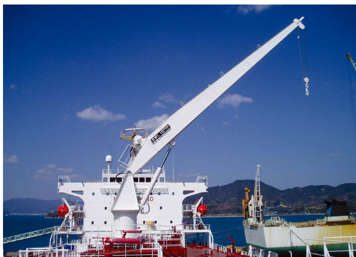
油圧式ホースハンドリングクレーン (10TON×19MR) Hydraulic type hose handling crane
