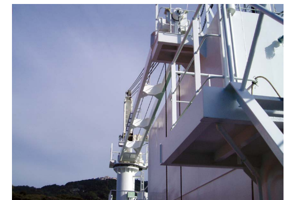
燃料ホース及びプロビジョンハンドリングクレーン (0.9TON×4.15MR) F.O.Hose handling & provision handling crane
