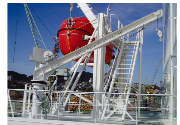
燃料ホース及びプロビジョンハンドリングクレーン (0.9TON×4.15MR) F.O.Hose handling & provision handling crane
