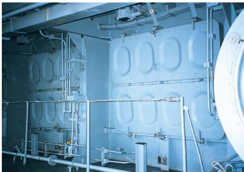
艙内通風開口装置 輸送艦「しもきた」に搭載(装備)
