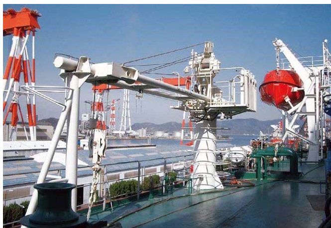
エアー式プロビジョンクレーン(2TON×7MR) Air type provision crane
