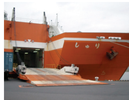
旋回式スターンランプ Swing type stern ramp
