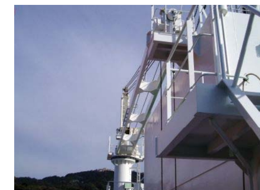
燃料ホース及びプロビジョンハンドリングクレーン (0.9TON×4.15MR) F.O.Hose handling & provision handling crane
