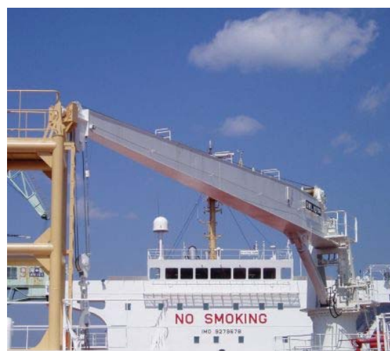
油圧式ホースハンドリングクレーン (10TON×19MR) Hydraulic type hose handling crane
