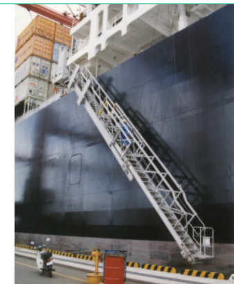
伸縮式水平格納型舷梯装置
