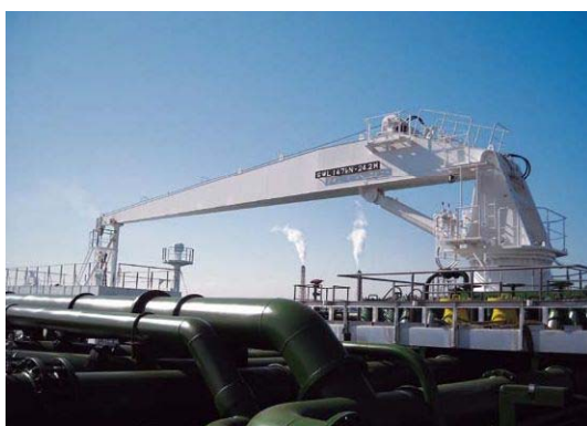
油圧式ホースハンドリングクレーン(15TON×24.2MR) Hydraulic type hose handling crane
