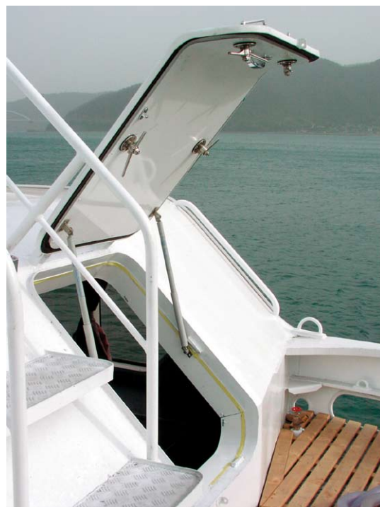
(上) アルミ上部構造とスケルトン窓 (右) 変型部に合わせて製作された水窓ガルウイングドアー
