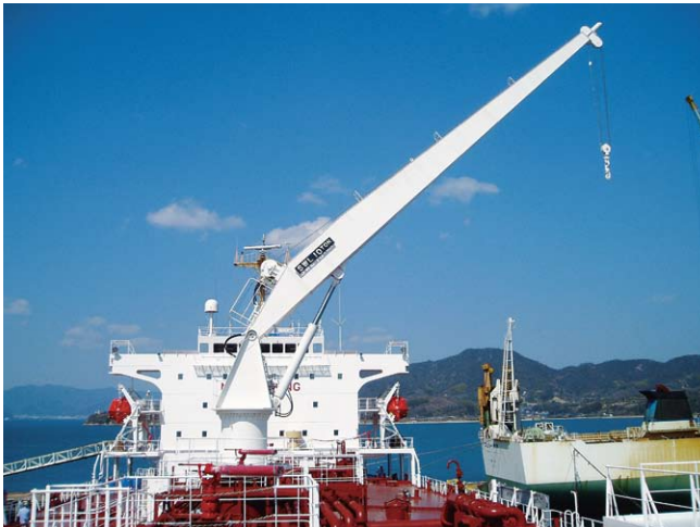
油圧式ホースハンドリングクレーン(10TON×19MR)
