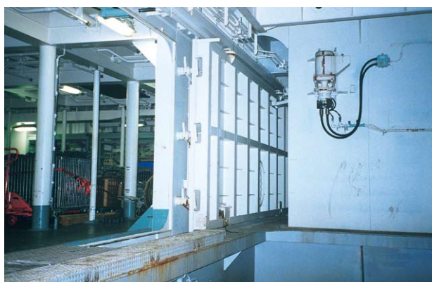
エアークッション艇通行用スライド式隔壁ドア
